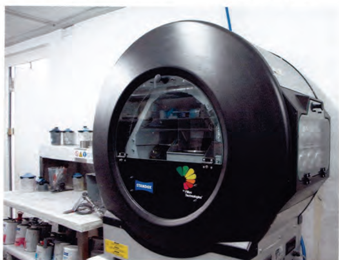
Das Mischen übernimmt die moderne Farbmischanlage Daisy Wheel – vollautomatisch und so präzise, wie kein Mensch mischen kann.
