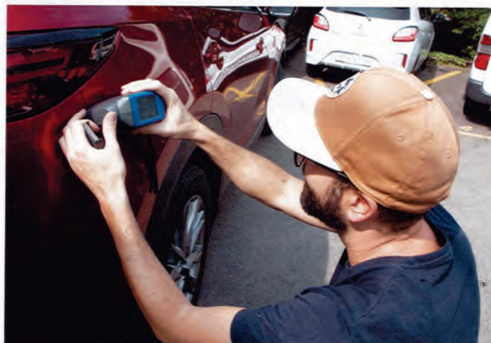
Mit dem Farbtonektrometer Genius iQ von Standox wird in Kürze der richtige Farbton ermittelt, der an die Standwin-Software im Farbmischraum weitergeleitet wird.
