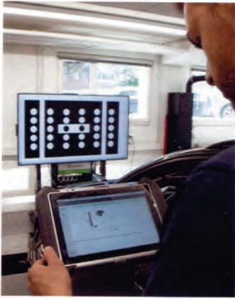
Die Neukalibrierung einer Frontkamera für einen Audi erfolgt an der modernen und unersetzlichen Kalibrierungsstation, die mit KI unterstützt wird.
